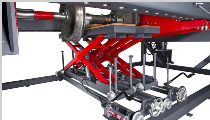
Die hydraulische Radsatzpresse Betex HWS 150t wurde gemäß Kundenvorgaben konstruiert. Sie wird zum Auf- bzw. Abpressen von Rädern auf Achsen und für weitere Komponenten wie Lager, Getrieberäder und Bremsscheiben eingesetzt.
