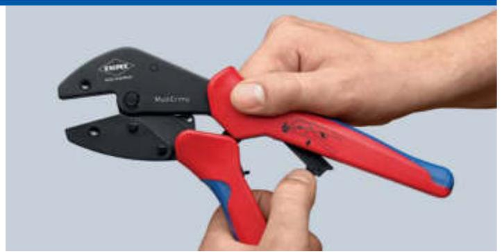
Wechselposition: Ausklappen des Service-Hebels für parallele Backenstellung
