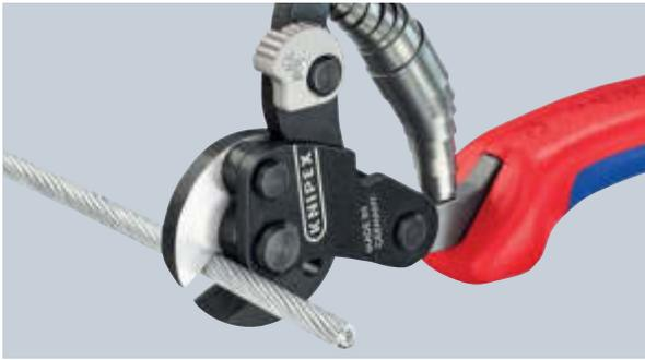
Schneiden von hochfesten Drahtseilen (1960 N/mm<sup>2</sup>) bis Ø 4 mm
