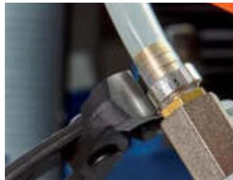
10 98 I220: Abdichten Schlauchanschluss an Zentralschmierung
