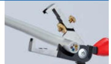
Induktiv gehärtete Scherschneide mit Präzisionsschliff zum quetschfreien Schneiden von Kupferkabeln bis Ø 15 mm (5 x 2,5 mm<sup>2</sup>)
