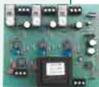
Steuermodul für Kaskadenschaltung von 2 Motoren
