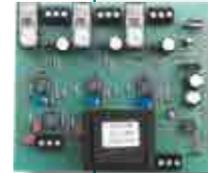
Steuermodul für Kaskadenschaltung von 2 Motoren
