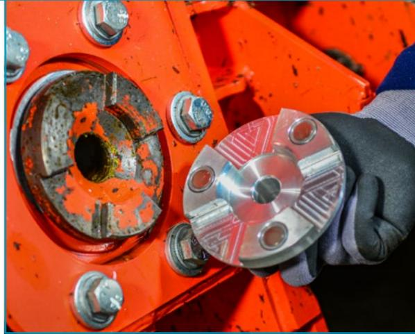
Werkzeug mit passendem Profil zum Schnellkuppler
