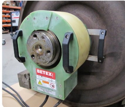
Erwärmung eines Lagerrings zur Demontage
