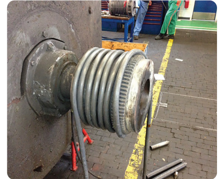
Erwärmung einer Kupplung zur Demontage
