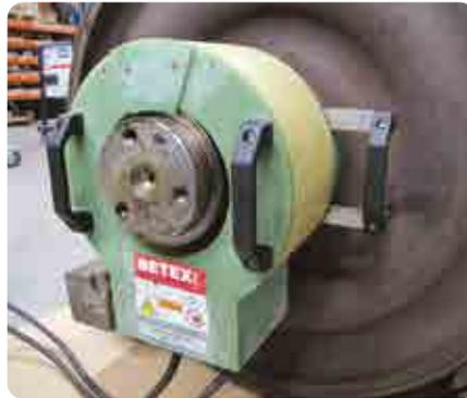
**Erwärmung eines Lagerrings zur Demontage**
