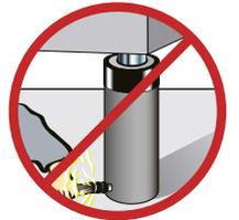
**14. Pumpe nicht durch Ziehen am Schlauch transportieren**
