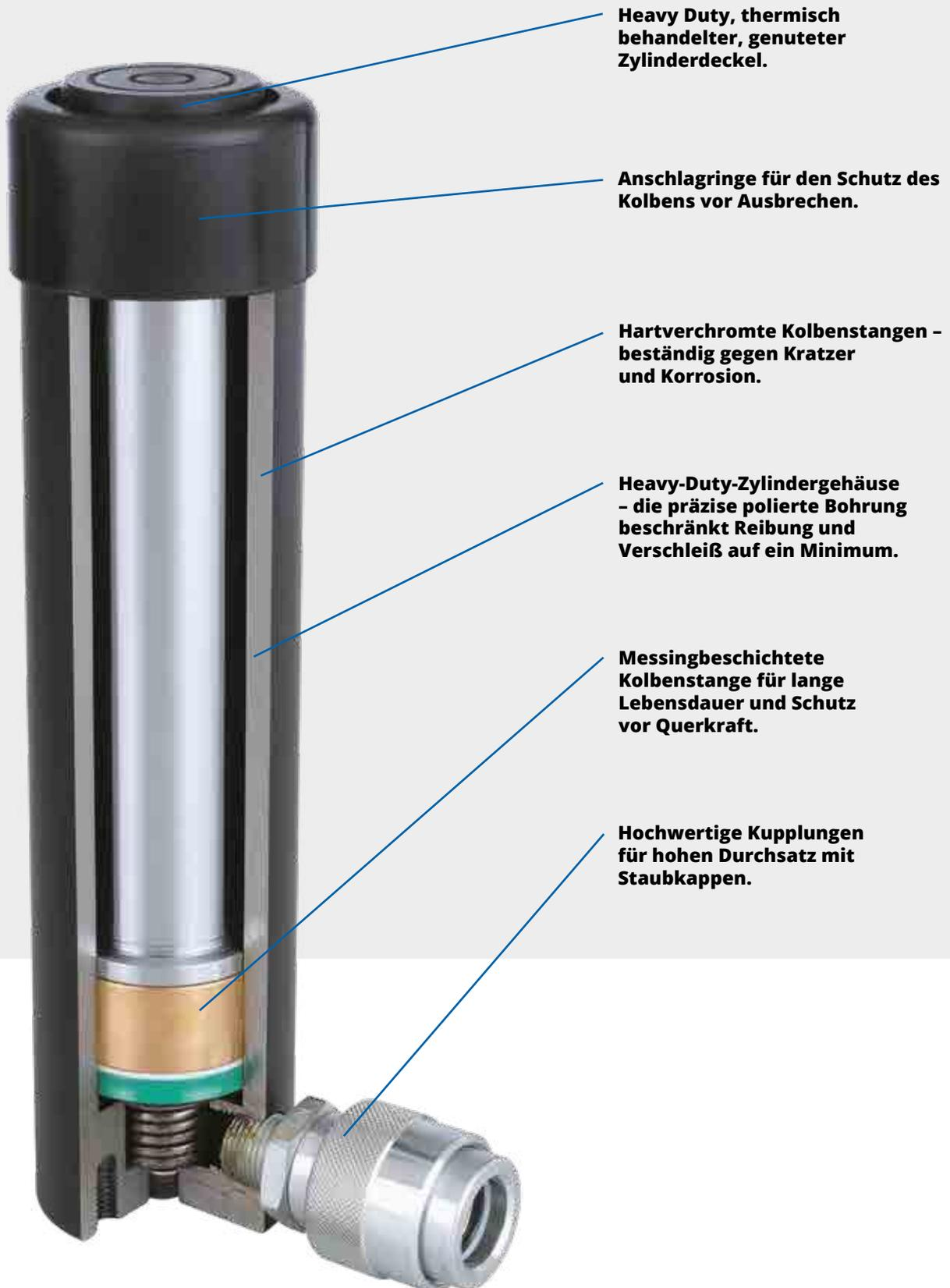
**Heavy Duty, thermisch behandelter, genuteter Zylinderdeckel.**
