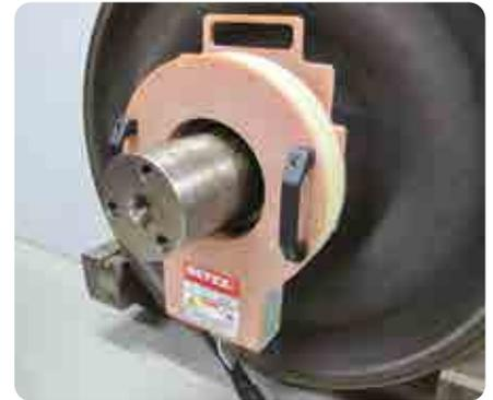
**Erwärmung eines Labyrinthrings zur Demontage**
