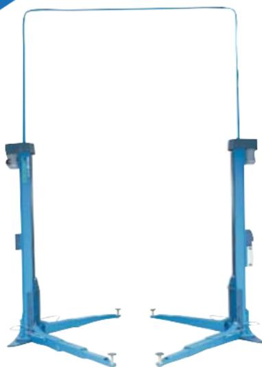
**Zweisäulen-Hebebühne für Kfz-Werkstatt und Reifenfachbetrieb, geeignet für Transporter und LLkw bis 5500 kg**
